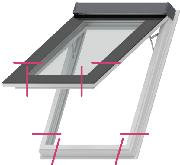
Diagrama esquemático de la disposición de los elementos de bloqueo.
